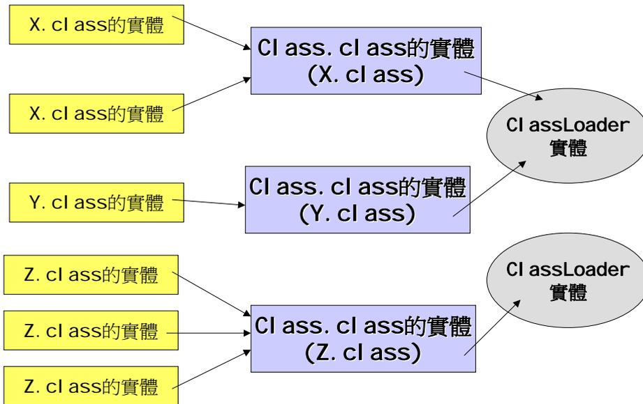
從上圖我們可以得之，系統裡同時存在多個 ClassLoader 的實體，而且一個類別載入器不限於只能載入一個類別，類別載入器可以載入多個類別。所以，只要取得 Class 類別實體的參考，就可以利用其 getClassLoader()方法籃取得載入該類別之類別載入器的參考。getClassLoader()方法最後會呼叫原生方法 getClassLoader0()，其宣告如下：
