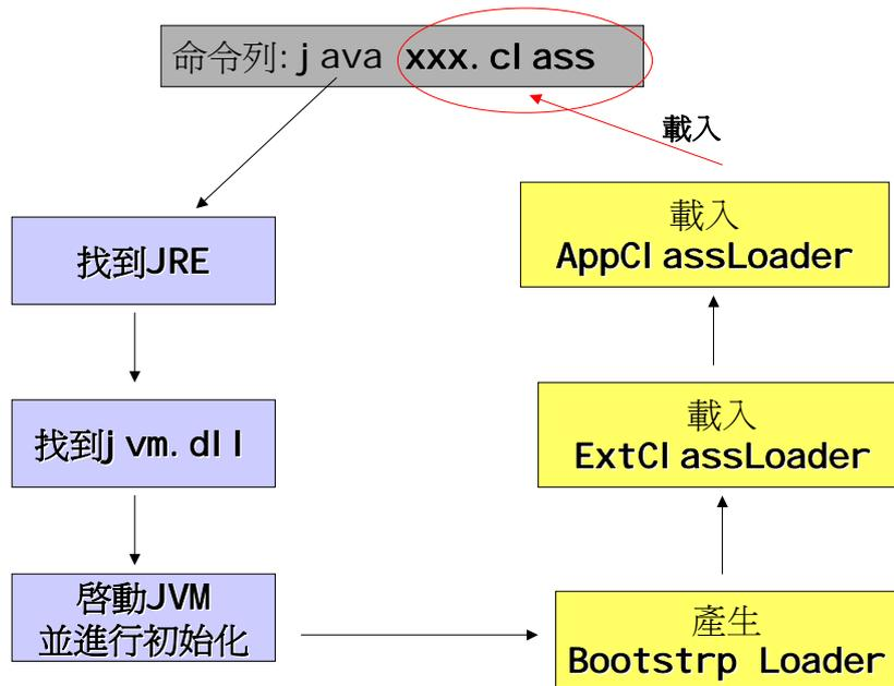
這個由 Bootstrap Loader → ExtClassLoader → AppClassLoader，就是我們所謂「類別載入器的階層體系」。我們可以用底下的程式碼證明這一點：
