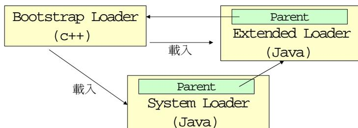
AppClassLoader 在 Sun 官方文件中常常又被稱做系統載入器(System Loader)，但是在本文中為了避免混淆，所以還是稱作 AppClassLoader。最後一個步驟，是由 AppClassLoader 負責載入我們在命令列之中所輸入的 xxx.class(注意:實際上 xxx.class 很可能由 ExtClassLoader 或 Bootstrap Loader 載入，請參考底下「委派模型」一節)，然後開始一個 Java 應用程式的生命週期。上述整個流程如下圖所示：
